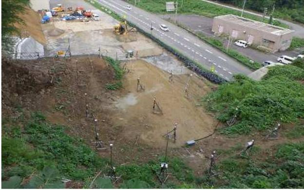
図-7 GNSS 地盤変位計設置風景
