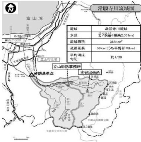
立山砂防事務所が砂防事業を実施している常願寺川は、北アルプスの北ノ又岳(標高2,661m)を水源とする真川と、立山連峰(最高峰3,015m)を水源とする湯川が樺平付近(河口から約40km地点)で合流し、その名を発しています。さらに千寿ヶ原(河口から約32km地点)で称名川、その下流で和田川(河口から約26km地点)や小口川(河口から約24km地点)を合わせつつ下流し、富山平野の東部を北流する流域面積345km<sup>2</sup>の河川です。その地形は極めて険しく、標高差約3,000mを延長56kmで一気に富山湾に流れ落ちる、世界でも有数な急流となっています。
